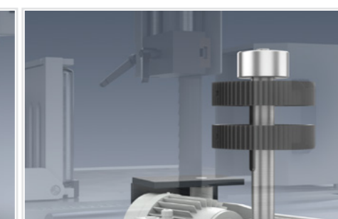
Deux rouleaux d'avance, suspendus sur ressort, cannelés et réglables en hauteur
