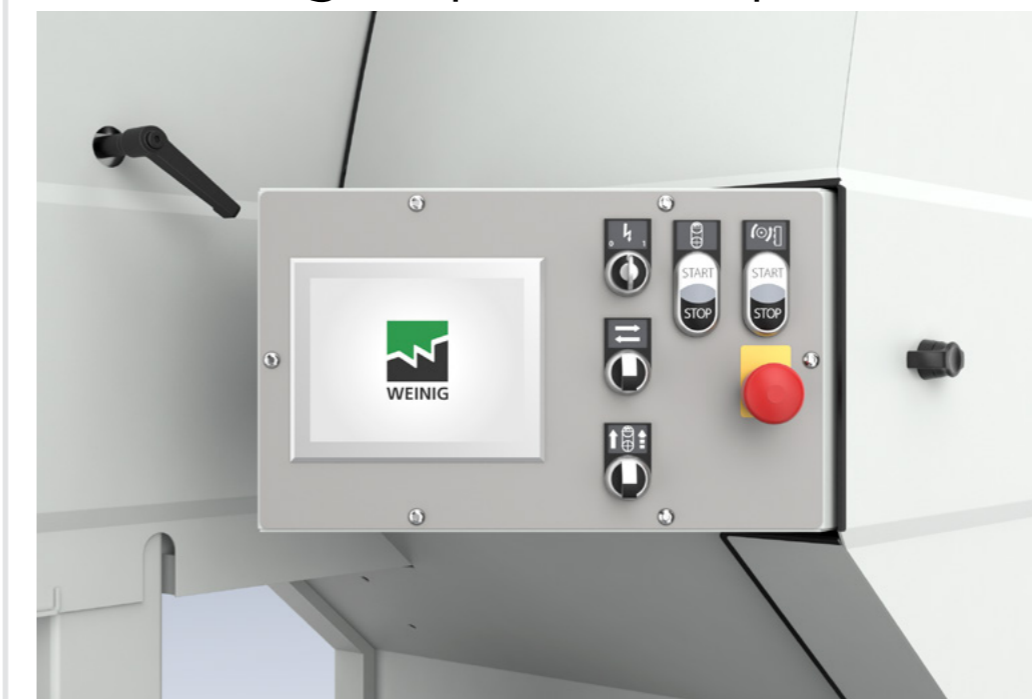
Ecran tactile pour entrée simple de la vitesse de la lame de scie à ruban et de la vitesse d'avance (par variation de fréquence), ainsi que des dimensions de découpe pour le positionnement du guide de largeur
