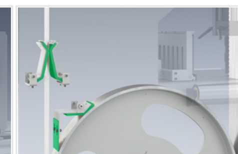
Nettoyage et graissage automatiques de la lame de scie à ruban et des deux volants
